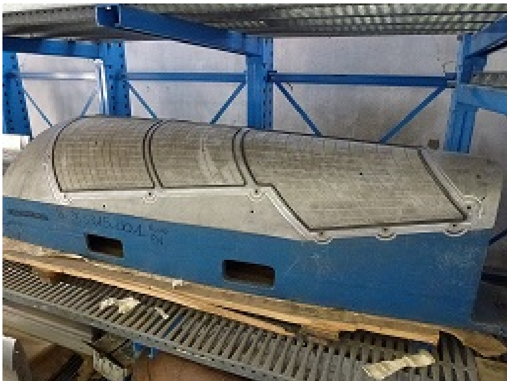
Rys. 5: Tradycyjna forma podpierająca stosowana w przemyśle lotniczym
