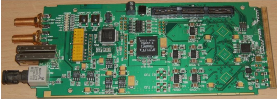
Rys. 26. Zaprojektowany moduł "AMC Timing Receiver" służący do generacji sygnałów zegarowych dla kaset ATCA.
