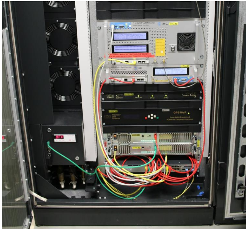
Rys. 21. Jeden z trzech kanałów systemu generatora wzorcowego zainstalowany w akceleratorze E-XFEL.
