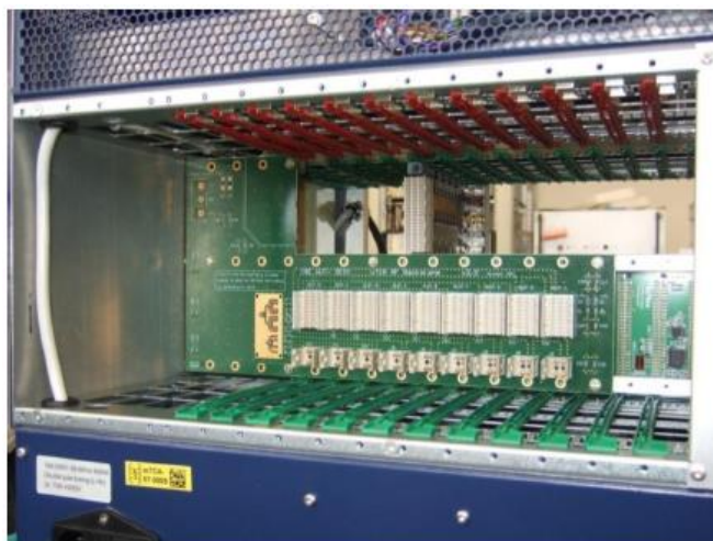
Rys. 31. Zdjęcie pierwszej wersji płyty RTM Backplane zamontowanej w kasecie MTCA.4.
