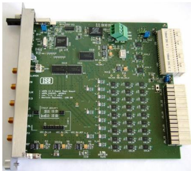
Rys. 32. Pierwsza płyta typu eRTM. Układ do testowania transmisji sygnałów zegarowych oraz w.cz. przez płytę RTM Backplane.
